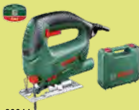
Cód. 80644 SIERRA CALAR PST 650 500 W. 3.100 cpm. Sistema SDS. Conexión para aspiración. Función de soplado. Longitud de corte: madera 65 mm, acero 4 mm. 1 hoja de sierra de calar para madera (T 144 D). Maletín.
