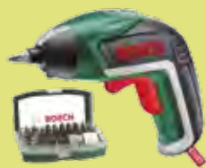
Cód. 125236 ATORNILLADOR 3.6V IXO 32 PUNTAS Batería de litio integrada 3,6V 1,5 Ah. Luz Powerlight. Máx par de apriete 4,5 Nm. 215 rpm en vacío. Cargador micro USB. Gratis Set de puntas con 31 puntas y portapuntas magnético.
