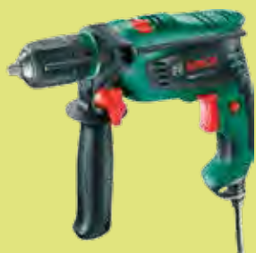
Cód. 121211 TALADRO PERCUTOR EASYIMPACT 550 550W. Mecanismo de impacto mejorado. Portabrocas una pieza. Máx. Ø perforación: 10mm hormigón, 8mm acero y 25mm madera. Preparado para sistema de aspiración. Empuñadura adicional, tope de profundidad y maletín.
