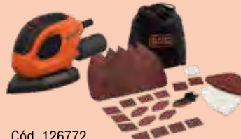
Cód. 126772 LIJADORA DE DETALLE MOUSE® BEW230BC 55W, velocidad 11.000 rpm, diámetro de órbita 1,5 mm, tamaño de hoja 110 mm/cm². Incluye 15 accesorios y bolsa de transporte.
