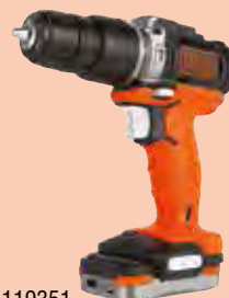
Cód. 119351 TALADRO PERCUTOR 12V BD-CHD12S1 Taladro Percutor 12V, portabrocas 10mm, 10 + 1 posiciones de par de apriete, 2 velocidades 0 - 350/1.350 rpm, par máximo 40Nm, impactos 21.250 ipm. Incluye 1 batería USB 1,5Ah de Litio y cable USB.
