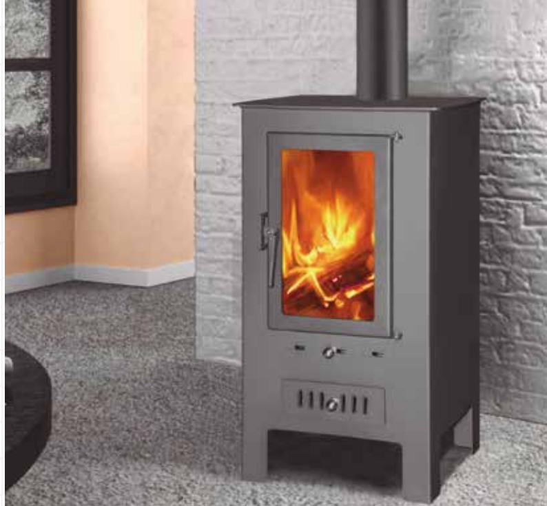
Cód. 102759 HOGAR LEÑA VIENA. THECA Salida de humos vertical Ø 120 mm. Combustible: sólo madera. Diámetro de carga: 240 mm. Potencia calorífica: 16 KW. Marca: CE. Estufa muy económica y de gran capacidad calorífica. 44 kilos de peso. Medidas: 900 x 510 x 360 mm.
