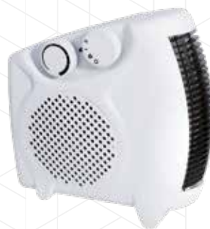
Cód. 122028 CALEFACTOR HORIZONTAL- VERTICAL. KUKEN Potencia: 2000 W. Voltaje: 220 - 240 V - 50Hz. Selector giratorio con 2 posiciones de potencia (1000/2000 W) + aire frío. . Rejilla de protección para evitar quemaduras. Luz led indicador encendido. Diseño compacto.
