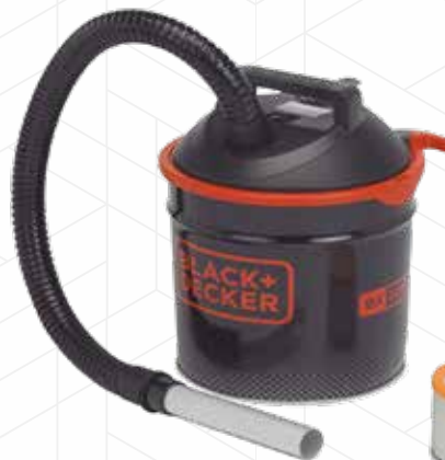
Cód. 122090 ASPIRADOR DE CENIZAS. BLACK&DECKER Potencia: 900 W. Presión de vacío: 150 mbar / 15 kPa. Aire aspirado: 28 l/s. Capacidad del depósito: 18 L. Limpiador de cenizas frías de chimeneas y barbacoas. Agitador de filtro. Depósito de acero inox. de lámina barnizada. Desenganche rápido para limpieza del depósito y filtro. Mango con rollo de cable. Motor silencioso con doble aislamiento eléctrico. Nivel de potencia sonora: Lp 73,6 dB(A) / Lw 87,6/90,6 dB(A). Tipo de filtro: de alta eficiencia con protección metálica H20. Longitud del cable: 2,5m. Voltaje: 230 V - 50 Hz. Acc. incl.: Tubo de succión de metal recubierto de aluminio, manguera metálica 40 mm Ø - 1 m de longitud y cartucho de alta eficiencia con protección metálica.
