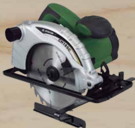
Cód. 110409 SIERRA CIRCULAR CH 185. STAYER Potencia 1200 W, Giros en vacío 4500 MIN-1. Dimensiones del disco Ø185x16 Z24. Corte inclinado 45°. Capacidad corte 90° 0-65 mm., Capacidad corte 45° 0-44 mm. Peso 4,8 Kg. Predispuesta para aspiración. Ligera y manejable.
