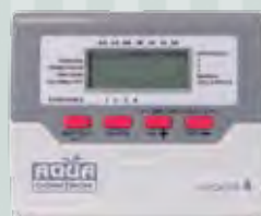
Cód. 87396 PROGRAMADOR 4 ESTACIONES Programador ACCESS 4 Zonas de riego. Uso interior. Transforma- dor externo. 2 programas independientes. Hasta 3 arranques al día por programa. Con arranque de bomba. Con función Consumo teórico de agua. Tiempo de riego desde 1 minuto hasta 10 horas.
