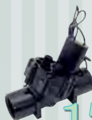
Cód. 79622 ELECTROVÁLVULA K HEMBRA SIN REGULADOR Medida: 1". Su piston inclinado permite una trayectoria directa del agua aumen- tando el caudal, a la vez que disminuye la pérdida de carga. Incluye purgador. Apta para uso con aguas residuales. Malla de filtración
