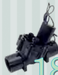
Cód. 75192 ELECTROVÁLVULA K HEMBRA 1" Con caudal regulable. Su piston inclinado permite una trayectoria directa del agua aumentando el caudal, a la vez que disminuye la pérdida de carga. Incluye purgador. Apta para uso con aguas residuales
