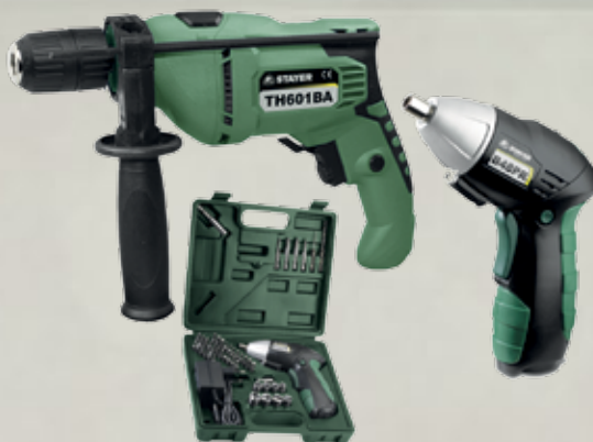
Cód. 103086 TALADRO PERCUTOR TH601BA + B48PRK. STAYER Reversible. Variador electrónico. Velocidad variable. Percutor. Empuñadura lateral con tope de profundidad. Portabrocas automático ø13 mm. Potencia 600W. Portabrocas mm ø 13. Capacidad perforación madera mm ø 25. Capacidad perforación acero mm ø 13. Capacidad perforación piedra mm ø 16. Reversible. Transformable en atornillador recto.
