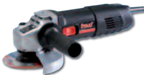
Ref. 83.9207 MINIAMOLADORA FREUD Miniamoladora 800W, 115Ømm, botón de bloqueo, empuñadura lateral, 11000rpm, peso 1,4 kg.
