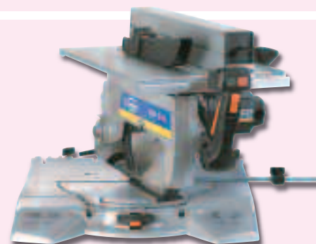
Ref. 83.1273 TRONZADORA ABATIBLE TM-33L VIRUTEX 1.500 W. Disco de 300 mm. de diámetro de metal duro y 48 dientes. Capacidad de corte hasta 95 x 160 mm. ó 45 x 200 mm. Amortiguador a gas. Sistema de freno patentado. Arranque progresivo.
