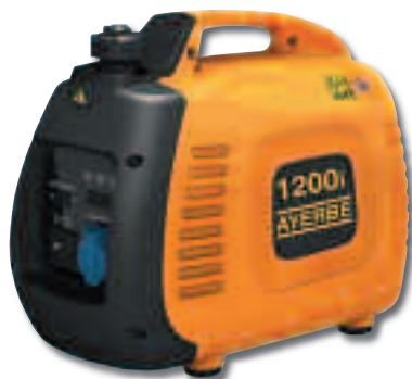
Ref. 83.147 GENERADOR INVERTER AY-1200 KT MOTOR KIOTSU KT 144 F AYERBE OHV 80 c.c. 1,5 HP. Alternador: SD 1 Kva. Potencia máx.: 1,2 Kva. Potencia nom.: 1 Kva. Depósito/Consumo: 2,1 l. Nivel sonoro: 83 dB. Dimensiones: 480 x 260 x 380 mm. Peso: 15,3 kg. 350,00€ + 63,00 = 413,00 €
