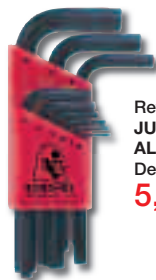
Ref. 83.138 JUEGO ALLEN BOLA DIAMANTE EN SOPORTE PLÁSTICO ALYCO Fabricadas en acero al cromo-vanadio especial S2, con código de colores para identificar la medida de cada llave, bocas imantadas para prevenir el deslizamiento de la llave. 1'5, 2, 2'5, 3, 4, 5, 6, 8 y 10 mm.
