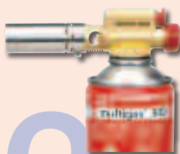
Ref. 83.906 SOPLATE "EASYFIRE" SUPER-EGO Mínimo consumo. Encendido piezoeléctrico. Boquilla de Ø 22 mm. Sistema de refrigeración. Regulador. Conexión para el cartucho. No incluye botella.
