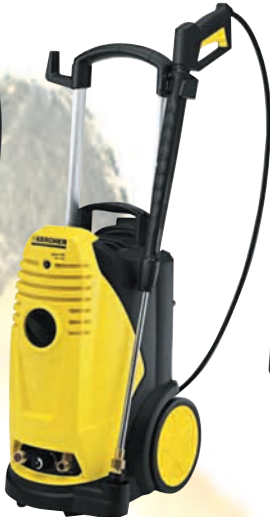
HIDROLAVADORA XPERT HD 7170 KÄRCHER Potencia 3,2 Kw. Presión 30-165 bar. Caudal 240-480 l/h. Limpiadora. Monofásica agua fría. Bomba de 3 pistones axiales con cabezal de latón. Motor refrigerado con aire.
