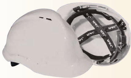
CASCO DE PROTECCIÓN JUMBO JAR Según normativa EN 397, que consta de una calota de polietileno, con agujeros de ventilación, un arnés interior textil, con sistema de regulación de rueda (52-63 cm.) y una sudadera de 22 cm.
