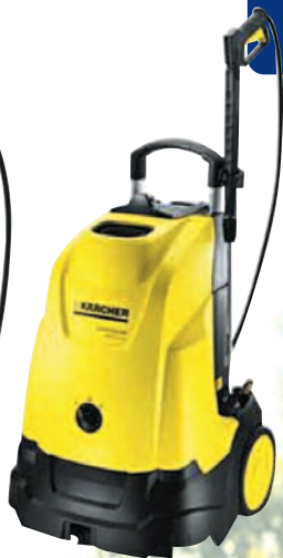
HIDROLAVADORA HDS 5/13 U KÄRCHER Potencia 2,6 Kw. Limpiadora de alta presión en agua caliente. Caudal: 500 l/h. Presión 125 bar. Alojamiento para los accesorios incorporado. Bomba axial de 3 pistones con cabezal de latón.
