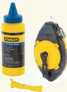
KIT CORDEL DE TRAZADO STANLEY Caja ergonómica de ABS de alta resistencia. Lateral transparente que permite visualizar el nivel de polvo. Rebobinado multiplicado: velocidad de enrollado 3,5 veces más rápida. Gancho extra-ancho de acero inoxidable. Manivela metálica plegable. Capacidad de polvo: 45 g. Posibilidad de uso como plomada. Incluye frasco de polvo de 113 g. y nivel de cordel. 8,80 € + 1,58 = 10,38 € Ref. 91.1191
