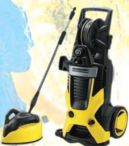
HIDROLIMPIADORA K 7.410 + T400 KÄRCHER Motor de inducción, parte superior de cilindro de latón, conexión rápida, sistema plug'n'clean, almacenamiento superior e inferior para la pistola de gatillo con lanza de spray adaptada, gancho de cable doble, grandes ruedas de exterior. Presión 160 bar - caudal 600 l/h. - Potencia 3.000 W.
