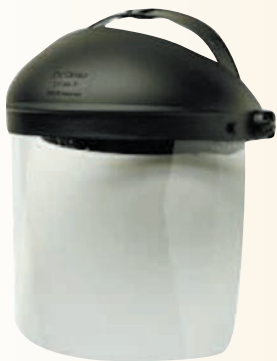
PANTALLA DE PROTECCIÓN FACIAL 424-RN CLIMAX Visor de acetato incoloro de 190x320 mm. Con tratamiento antiempañante. Certificada CE.
