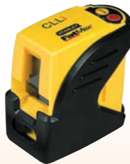
NIVEL LÁSER CRUZ AUTONIVELANTE STANLEY Proyecta una línea horizontal, vertical y cruz con posibilidad de modo manual para trabajos en techos y en diagonal.
