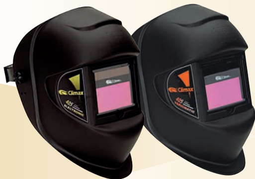
PANTALLA ELECTRÓNICA DE PROTECCIÓN CLIMAX Fabricada en poliamida con fibra de vidrio. Filtro electrónico que varía automáticamente de tono claro a oscuro al iniciar la soldadura. Certificada CE.
