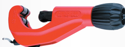
CORTATUBOS TELESCÓPICO 742 PRO SÚPER-EGO Capacidad: 6-42 mm Ø. Cuchilla de repuesto en el pomo. Para todo tipo de tubos: cobre, PVC, multicapa, inoxidable. 25,50 € + 4,59 = 30,09 € Ref. 91.1105
