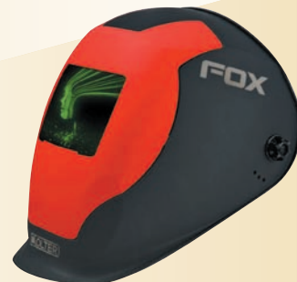
PANTALLA ELECTRÓNICA FOX 20R ROJO SOLTER Pantalla electrónica regulable DIN 9-13. Microregulable en sensibilidad y en esclarecimiento. Tono claro DIN 4. Gran campo de visión 67x100 mm. Peso sólo de 360 g. Ideal para MMA, MIG y TIG todos los amperajes.
