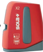
NIVEL LÁSER AUTONIVELANTE X2 SOLA De líneas vertical y horizontal. Posibilidad de bloqueo para trabajar como tiralíneas en modo manual. IP52. Protección del péndulo mediante bloqueo cuando se apaga el láser. Risca directa a tripodes standards 5/8". 117,45 € + 21,14 = 138,59 € Ref. 91.46
