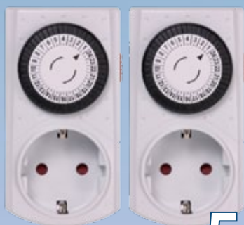
Cód. 82110 PACK DE 2 PROGRAMADORES MINI 2 programadores. Interruptor de Funcionamiento Uñetas Imperdibles. Tiempo de Maniobra de 30 min. 48 maniobras por día. 230V, 50Hz, 16(2)A. 3680W
