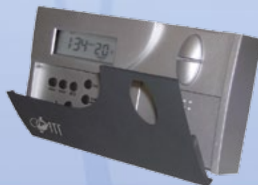
Cód. 60412 CRONOTERMOSTATO DIGITAL 10 PROGRAMAS Cronotermóstato digital para sistemas fijos de calefacción. Dos programas predefinidos y ocho a definir por el usuario. Interruptor On/off, función anti-hielo Ajuste diferencial 0,2°C - 1°C. Color Gris/Plata
