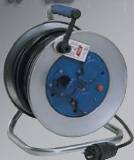
EXTENSIBLE CARCASA METÁLICA. TAYG Extensible eléctrico Cable H05VV-F 3x2'5. 3 bases (2P+T) con termostato y tapa. Potencia máxima 250V 16A 4000W. IP-55. Cód. 46602- 25 metros. Cód. 46603- 50 metros.
