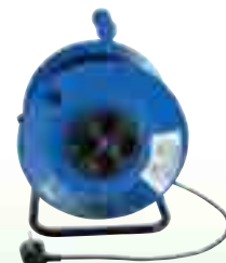
Cód. 64398 EXTENSIBLE ELÉCTRICO CON TERMOSTATO Cable H05VV-F 3x1'5MM. 50 metros 4 bases (2P+T) con termostato Potencia máxima 230X 13A 3000W Diámetro de carrete 265 mm IP-20
