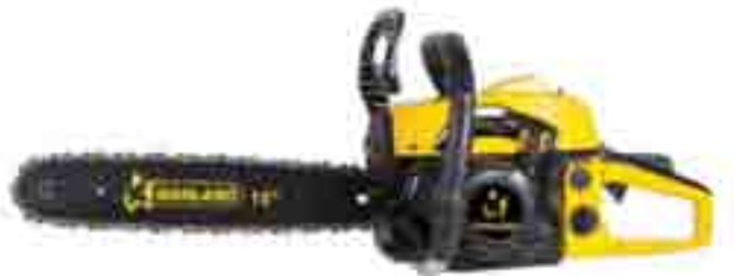
Cód. 81895 MOTOSIERRA GASOLINA FOREST 716. GARLAND Motosierra 45,8 cc, barra de 16" ( 40 cm ). Cadena paso 0,325/0,058. Freno de cadena, sistema antivibración, engrase automático de la cadena, primer cebador. Sistema de arranque fácil EASY START..
