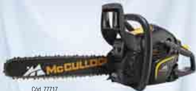
Cód. 77717 MOTOSIERRA GASOLINA ÉLITE CS450. McCULLOCH Potencia del motor: 2kw / Cilindrada: 46 cc Longitud espadín: 18" / 45cm, Paso de cadena: .325" Peso: 5,3kg. Nuevo diseño McCulloch- Made in Suecia OXYPOWER: Sistema de motorización limpio: más potencia, menos consumo de gasolina y menos contaminación Válvula de descompresión y SOFT START: reduce el esfuerzo al arranque (-40%) CCS: Sistema de purificación del aire para una larga vida útil de la máquina con menos mantenimiento del filtro de aire Sistema anti-vibraciones de alta calidad.
