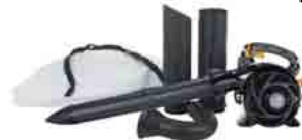
Cód. 76976 ASPIRADOR SOPLADOR TRITURADOR GBV345. McCULLOCH Potencia del motor : 0,75 Kw Cilindrada : 25 cc Velocidad del aire : 347 km/h Capacidad de aspiración : 730 m3/h Capacidad de triturado muy alta: 16:1 (con cuchilla) Capacidad del cesto recogedor: 45 litros (con correa) Empuñadura antivibración + soft grip SOFT START: reduce el esfuerzo al arranque (-40%) Velocidad variable Peso: 4,4kg
