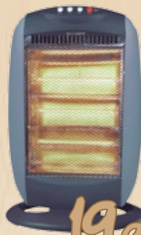
Cód. 70017 ESTUFA HALÓGENA Barras halógenas. 3 niveles de potencia 400/800/1200w. Interruptor de seguridad. Antivuelco. Medidas 35x17x56,5cm
