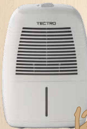
Cód. 97534 DESHUMIDIFICADOR TECTRO Deshumidificación 10 l/d * Deshumidificación a 32 °C, 80% RH Deshumidificación **1/24 h6 * Deshumidificación a 27 °C, 60% RH Potencia Consumida 0.29 kW. Volúmen de la estancia 40 – 60 m3. Dimensiones (ancho x prof x alto) mm 335 x 280 x 435. Capacidad del depósito 11.4. Económico y efectivo. Drenaje continuo. Apagado automático. Función anticongelación. Depósito de agua extraíble. Higrostat. Función Auto-Restart. Compresor: El deshumidificador posee un compresor rotativo silencioso. Fácil de desplazar. Incluida asa superior
