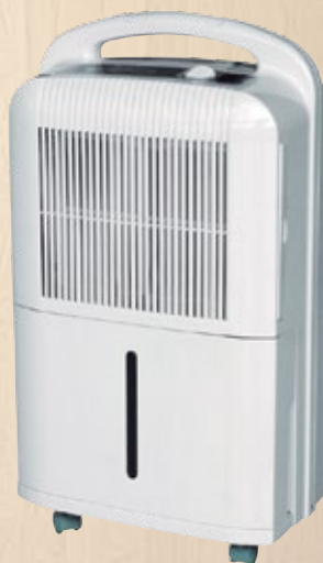
Cód. 47450 DESHUMIDIFICADO MANUAL KAYAMI Capacidad de deshumidificación: 12 l/día (30°C y 80%hr) control: selector manual de humedad con indicador de depósito lleno. Alimentación: 220-240v 50hz peso: 11.2 kg. Consumo eléctrico: 200 w dimensiones: Alto x ancho x fondo 570 x 320 x 230 (mm). Nivel sonoro: 38 db filtro: nylon. Temperatura de funcionamiento: min 5°C – max 35°C posibilidad drenaje continuo: sidosescarche automático: si ruedas: (4) capacidad del depósito: 3.5 litros garantía: 2 años superficie máxima recomendada a deshumidificar: 40 m2
